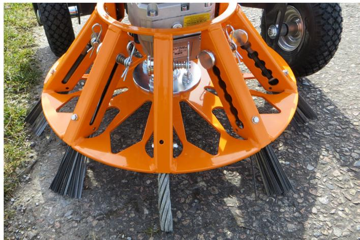
Die Wildkrautbürste kann mit zwei verschiedenen Bürstenarten arbeiten: Flachstahlbürste und Drahtbürste. Wenn man von Flachstahlbürsten zu Drahtbürsten wechseln will, muss der M6x60 Maschinenbolzen unten am Bürstenprofil herausgeschraubt werden, ein neuer M6x40 Maschinenbolzen ist vor dem Einsetzen der Bürste durch das andere Ø7-Loch des Bürstenprofils zu schrauben.
